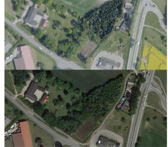
Figur 3 Skotskævej og krydsningen af Baskidevej før og efter anlæggelsen af den dobbeltrettede cykelsti på den nordlige side af vejen. SDFE Skråfoto maj 2017 (øverst) og Google Kartdata 2021 (nederst).
